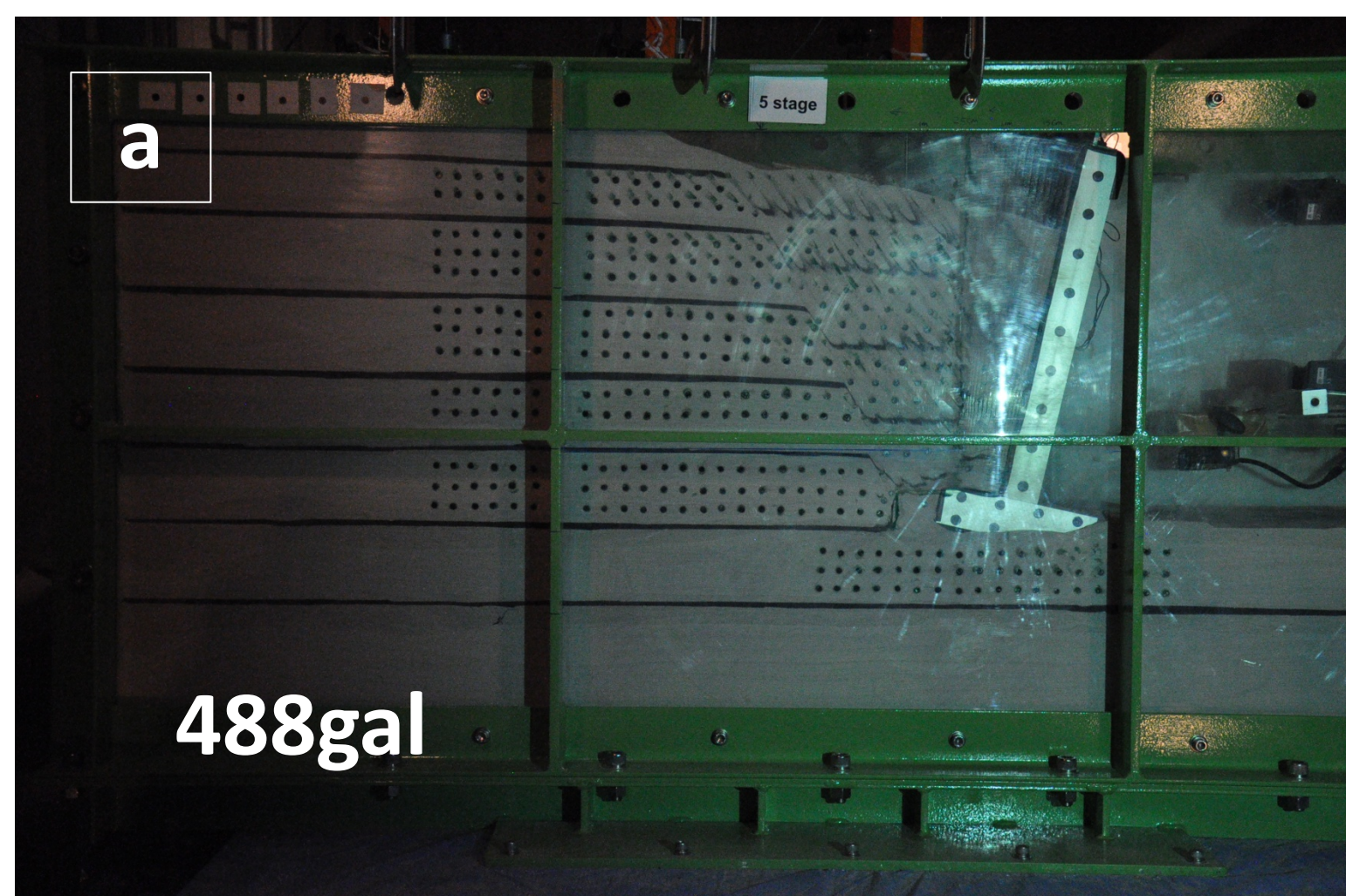
擁壁の破壊状況と破壊加速度 a)従来型擁壁 b)ジオグリッド補強土擁壁 c)改良型ジオセル補強土擁壁
