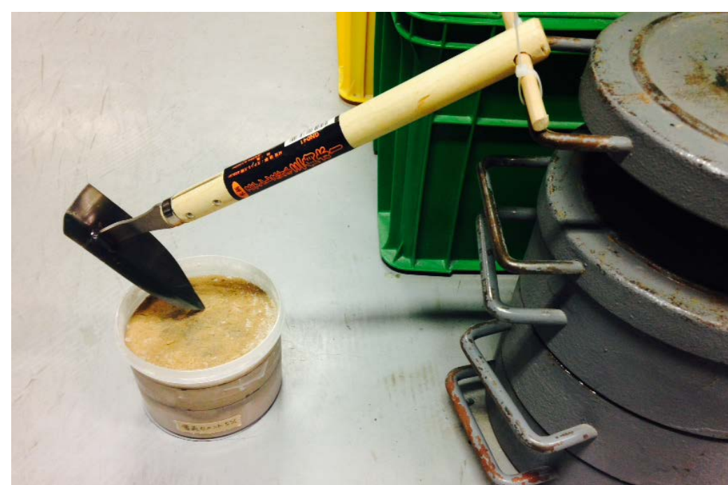
図-2 三角ホーを用いた掘削試験
