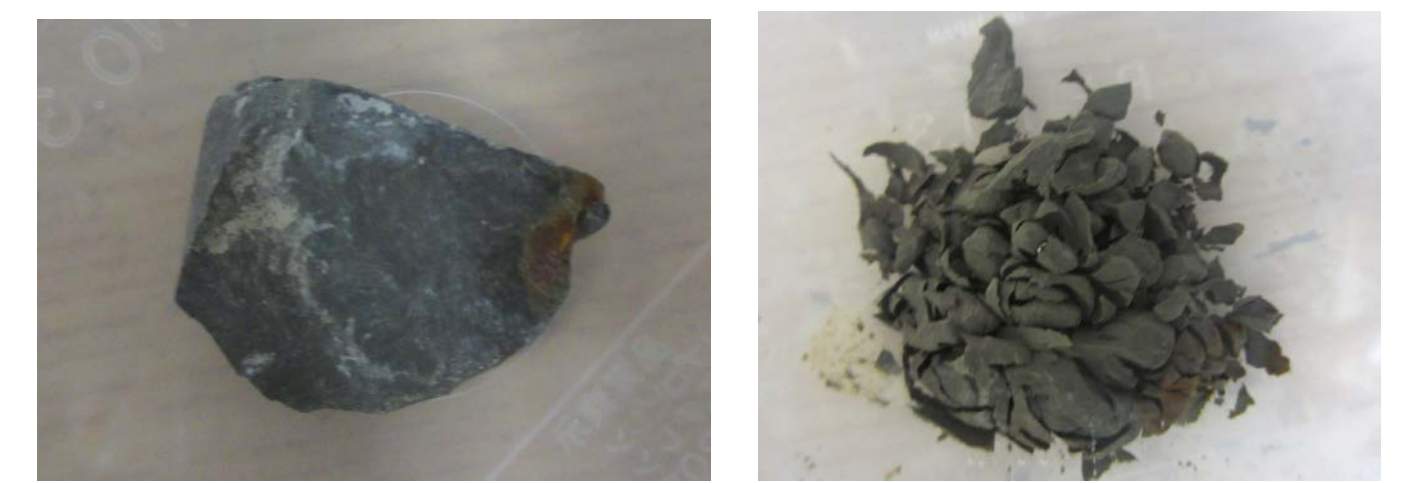
図1 乾湿繰り返し前(左)と後(右)の泥岩
