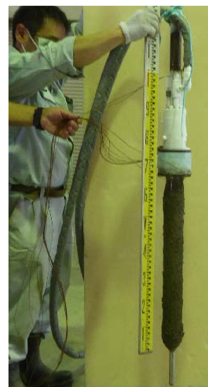
小規模凍結サンプリングで凍結後採取された試料
