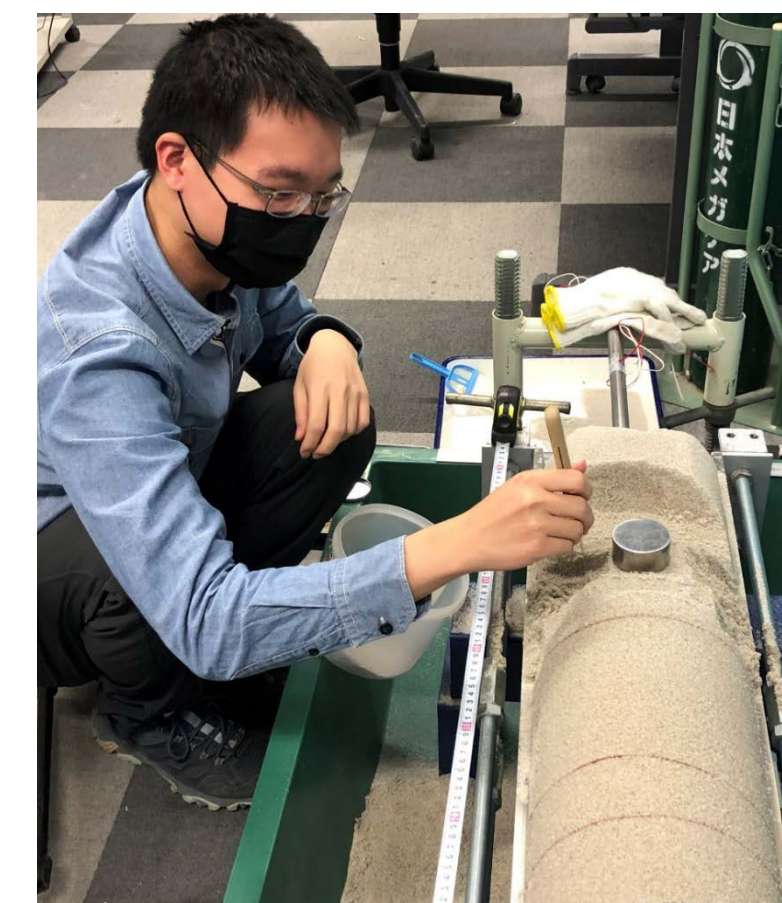
ブロックサンプリングによる密度の測定中の様子
