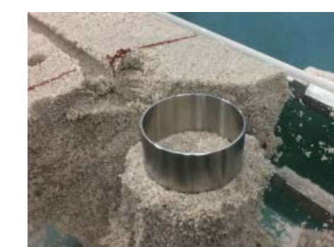
ブロックサンプリングのケース (Φ50mm、高さ25mm)
