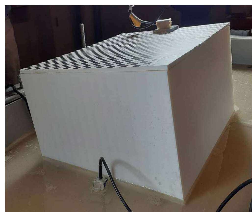
Test01 構造物(350gal加振後)
