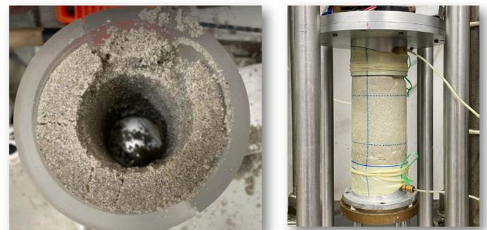
中空供試体の作成および品質評価
